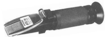
図 糖度の測定に使用する機器
